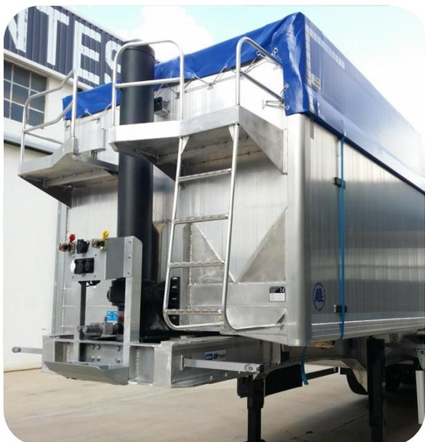
❖ Construcción gran volumen, hasta 2.000 mm de altura interior útil para altura de quinta rueda de 1.200 mm. Volumen útil máximo con caja de 12.600 mm. de 62 m<sup>3</sup>.
